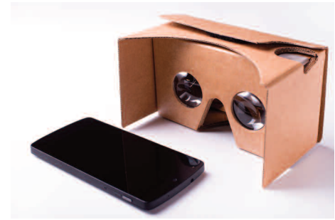
Google Cardboard-brillerne er et stykke foldbart pap, du kan indsætte din smartphone i. Papbrillerne er opdelt til højre og venstre øje og ved at downloade nogle specialiserede programmer, får du en VR-oplevelse for under 10 €. Da Google sendte papbrillerne på markedet i 2014 sparkede det konkurrencen i gang for de store tech-giganter om, hvem der først kunne komme med et par VR-briller til en pris, hvor den almindelige forbruger kunne være med.
